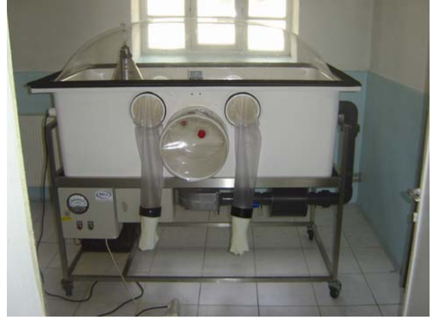
Resim 2. ICPI testinde kullanılan izolator.
